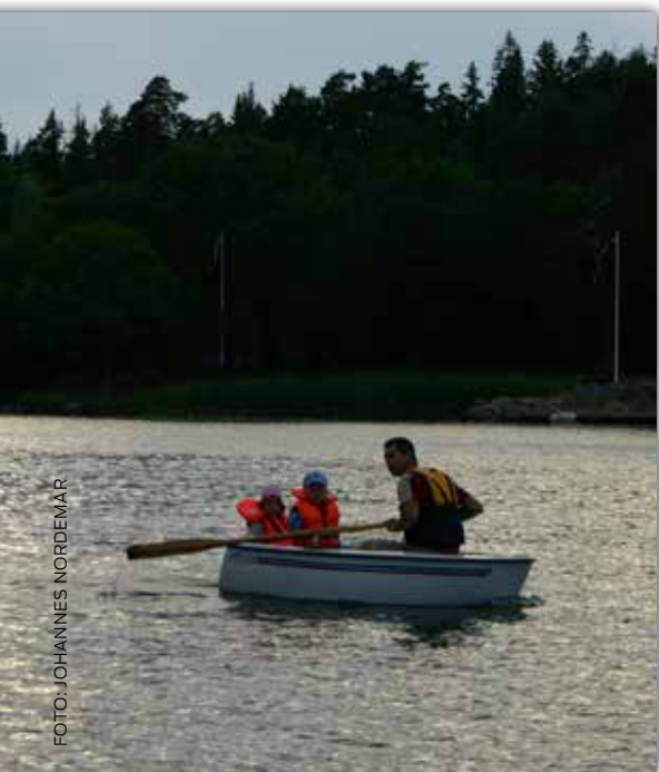
En roddbåt är displacerande och kommer att ha en maximal skrovfart utifrån båtens vågbildande längd.
