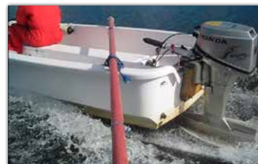
Med hjälp av en midskeppsinterceptor och ett stabiliserande plan på motorns rigg kan skrovets våta yta minskas avsevärt. Jürgens 5,6-metersbåt gör drygt 19 knop med en åtta hästkrafters motor.
