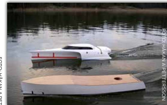
En modell av Håkans motortrimaran har använts som referensbåt när släptester gjorts med skrovmodeller.
